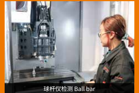
球杆仪检测 Ball bar
